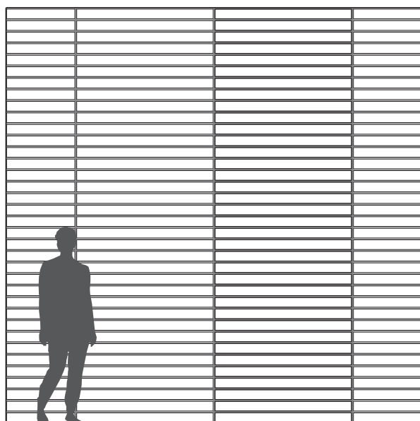
Troldtekt v-line 2way 6 monteret i vandret helforbandt.
