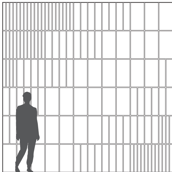
Troldtekt tiles monteret i forløb
