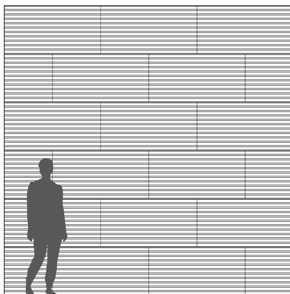
Troldtekt line monteret vandret
